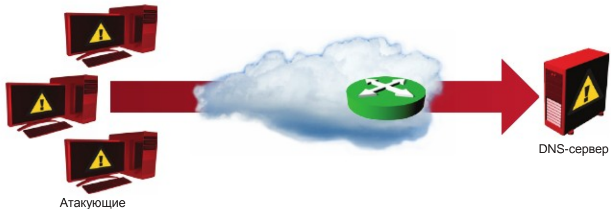
Рисунок 16: Во время «мусорного» DNS-флуда злоумышленник переполняет DNS-сервер пакетами данных большого размера, которые отправляются на UDP-порт 53. При организации такой атаки злоумышленники пользуются тем, что организации всегда держат DNS порт открытым и не станут блокировать его трафик на уровне маршрутизатора.
