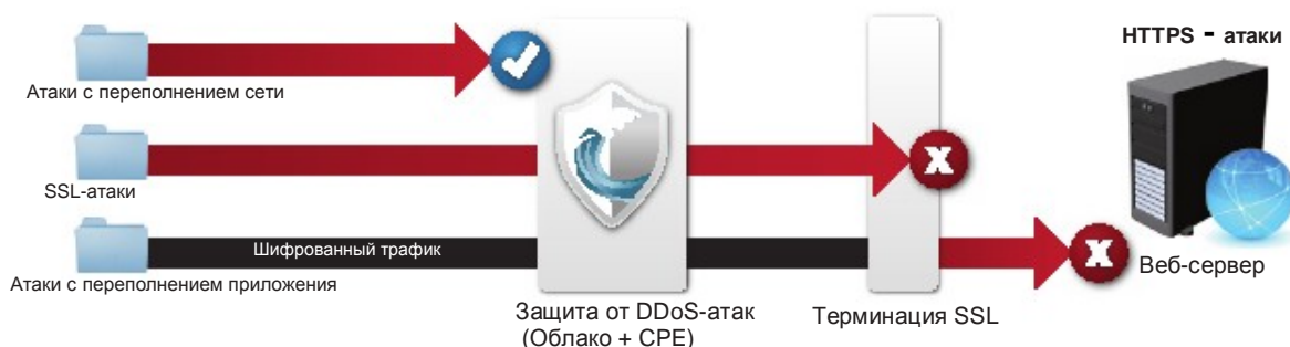
Рисунок 18: Атаки по протоколу HTTPS не фиксируются системами защиты, расположенными в облаке или на оборудовании клиента. Трафик по HTTPS на уровне приложения шифруется, и поэтому он не может быть проверен защитными механизмами. Кроме того, HTTPS уязвим для атак с уникальным SSL.
