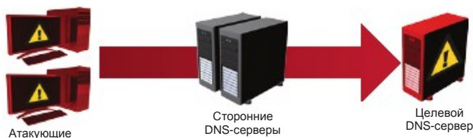
Рисунок 13: В процессе атаки путем отражения DNS-запросов злоумышленник посылает DNS-запросы сторонним серверам, заменяя IP-адрес источника запроса на IP-адрес целевого сервера (объекта нападения). Ответ, отправляемый сторонними серверами, достигает целевого DNS-сервера, увеличившись в 3-10 раз.
