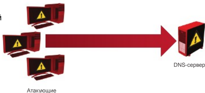
Рисунок 12: Используя простой DNS-флуд, атакующий отправляет большое количество DNS-запросов на целевой DNS-сервер, переполняя его запросами и выводя его из строя.
